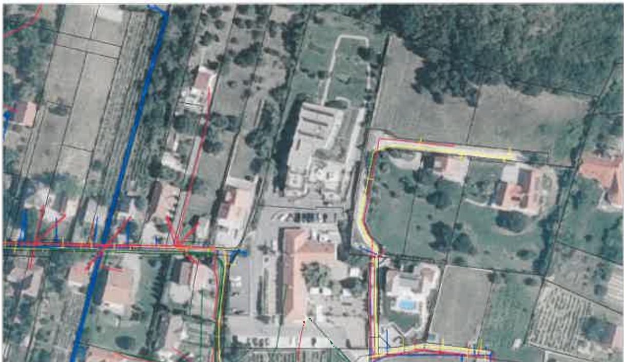
Az 1.1. indítvány módosítási területének közműtérkép részlete (piros villamos energia, kék vízellátás, sárga szénhidrogén, zöld távközlés)
